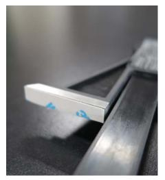
まず、金属・一般材料用薄手の両面テープ (Scotch:超強力)を測定面の裏に張り、アームを 張り付けた。
